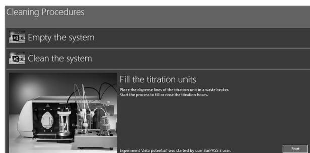
Fig. 25: Fill the titration units
